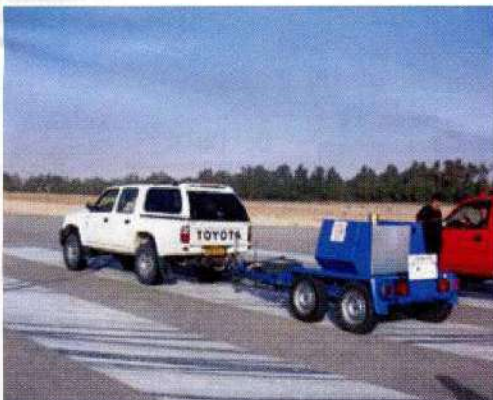
Figure 1: Le déflectomètre HWD sur la PP 18/36
